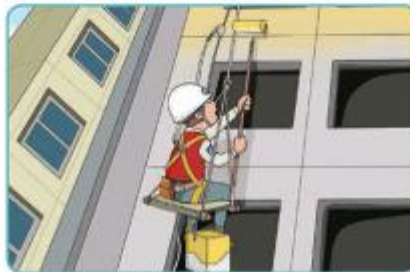
5 달비계 작업 시 안전대 및 구명줄 설치
