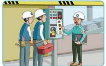
3 기동장치 잠금조치, 표지판 설치
