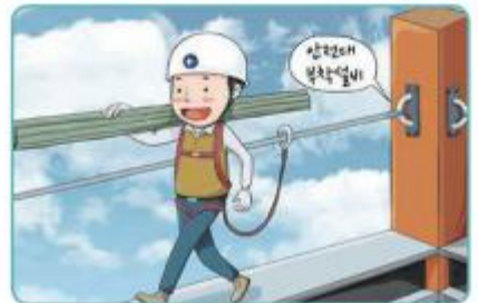
6 안전대 착용 시 안전대 부착설비 설치
